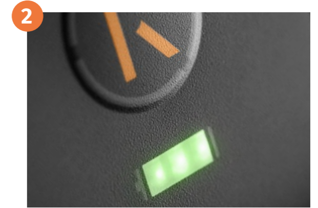
Einschalten durch kurzes Drücken der Start-/Stopp-Taste „K“. Es leuchtet die Ladestandsanzeige auf. 3 x grün = volle Ladung, reduziert sich bei Verbrauch auf 2 x grün, 1 x grün, orange, rot=bald leer.
