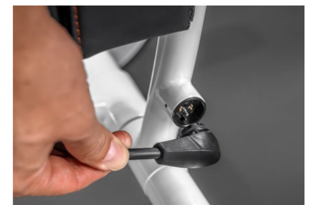
Akkuanschluss mittels Magnetstecker. Stecker zeigt dabei waagrecht nach vorne. Blinksignal an der oberen Steuerungseinheit zeigt erfolgreichen Akkuanschluss an.
