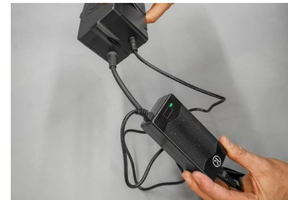
Erst wenn ein spürbarer Widerstand beim Anschluss an den Akku überwunden ist, sind Akku und Ladegerät korrekt verbunden. Der Ladevorgang kann beginnen.
