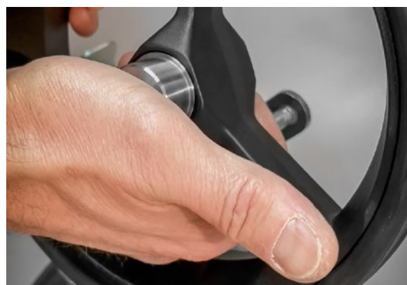
Rad anbringen. Den Metallknopf beim Aufstecken des Rades mit dem Handballen gedrückt halten. Bis zum Anschlag aufschieben (Achsrille).
