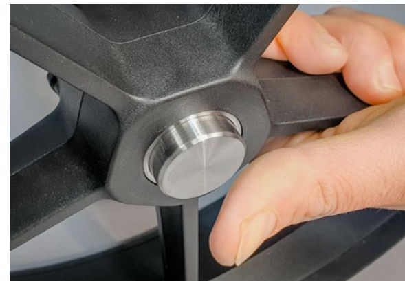
Durch loslassen des Knopfes verriegelt das Schloss auf der Achse. Die vordere Rille auf der Achse dient zum Verriegeln zum Freilauf ohne Motorantrieb.
