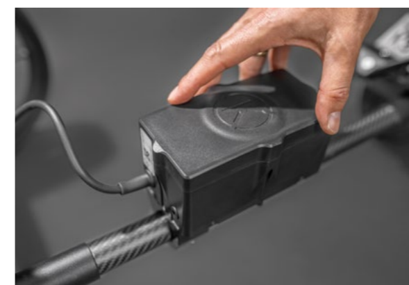
Vordere Kante bündig mit der fest montierten Akkuauflage.
